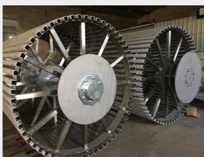
装置内部结构（除电机外）全部采用不锈钢和铝合金材料，卫生条件好，配有优秀的清洗系统，使装置内无积物污染。
