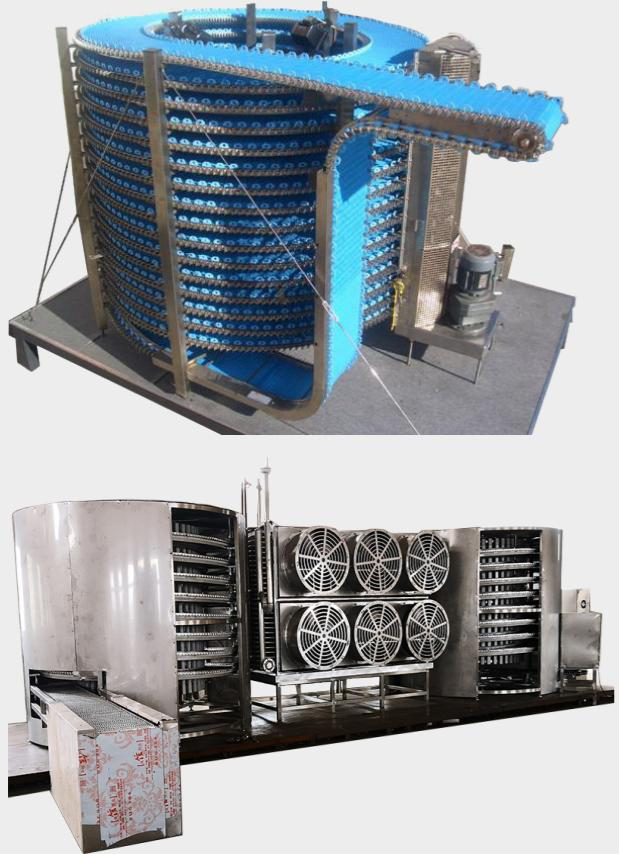
BJ-SDX系列螺旋式速冻机是一种技术先进、适用面广、占地面积小、冻结能力大的节能型快速冻结装置，在普通型的基础上，作了进一步的完善和改进。采用模块化或整体化一次灌泡成型的地坪，使设备性能和结构更完善、稳定性、保温性得到进一步提高和加强。
