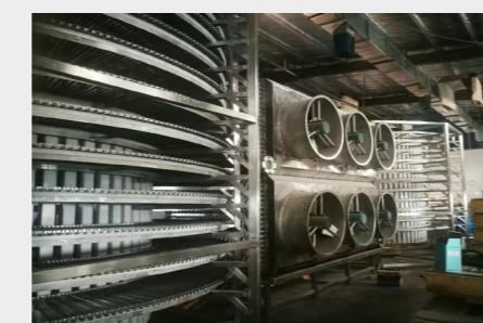
装机容量较一般隧道式降低35%，整机耗冷量少，提高少冻结的经济性。
